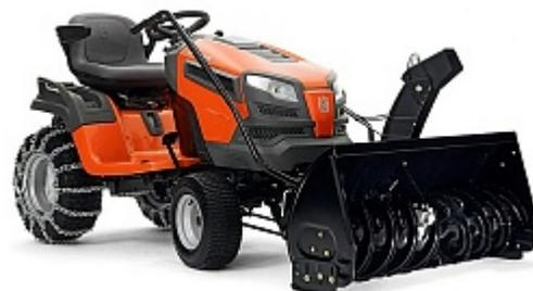
При работе в зимнее время на колеса трактора необходимо устанавливать цепи!
